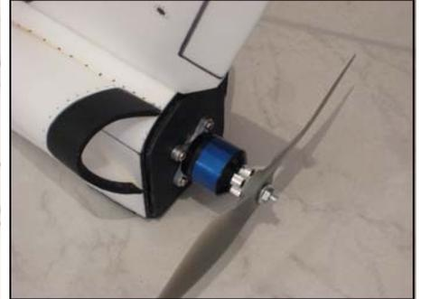
Der Motorspann ist bereits eingeklebt. Motor draufschauben - fertig.
