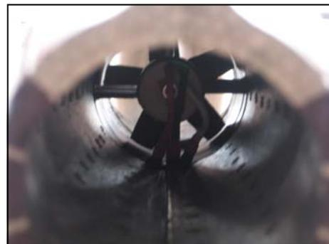
Hier ist der Impeller inkl. Motor und Anschlusskabeln zu sehen.
