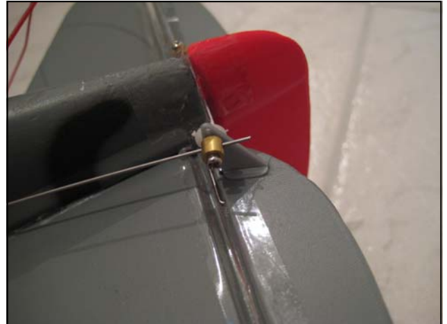
Hier sind die Anlenkungen zu sehen. Aus Komfortgründen wurde das mit Gestängeanschlüssen realisiert.
